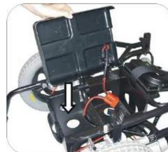
12. Após remover as baterias, feche a tampa da caixa da bateria.
