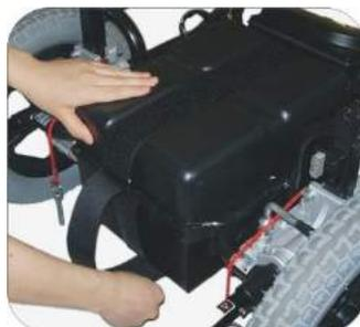
8. Desaperte o velcro da parte inferior da caixa da bateria.
