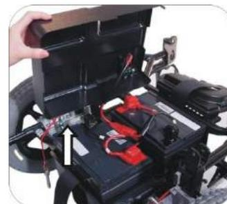
9. Abra a tampa da caixa da bateria para a esquerda.
