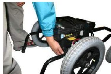
1. Coloque a caixa da bateria de uma só vez e verticalmente (Figura 6-1)
