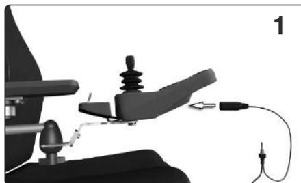
*Conexão do cabo de funcionamento de emergência na tomada.*
