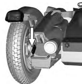
*Imagem 107. Alavanca de desbloqueio dos travões com lingueta de segurança*
