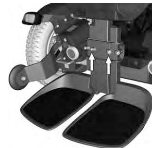
*Imagem 21. Ajustamento do comprimento do apoio das pernas*
