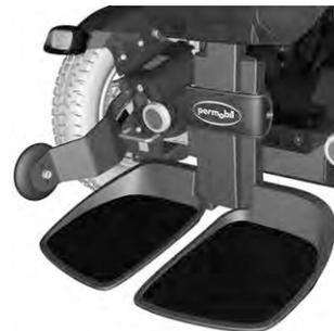
*Imagem 20. A cobertura do apoio das pernas é montada com dois parafusos.*
