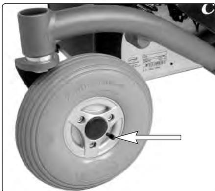
*Válvula de ar do pneu dianteiro.*
