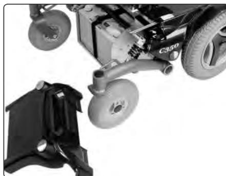
*Tampa dianteira do chassi desmontada.*
