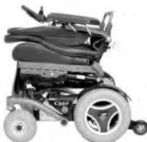
*Dimensões mínimas para efeitos de transporte = comprimento 900 mm., largura 625 mm., altura 790 mm.*
