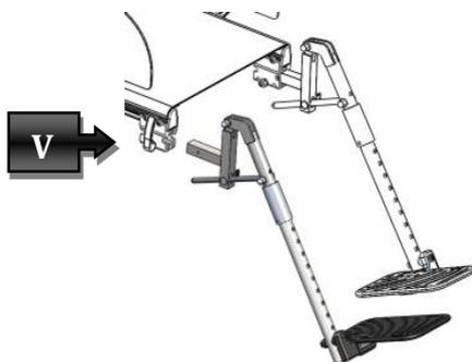
**Figura 59 – Apoio de pés elevatório de mola de compressão (ou extensão)**
